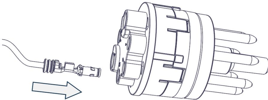
Einzeladerdichtung sollte mehr als 1mm unterstehen.
