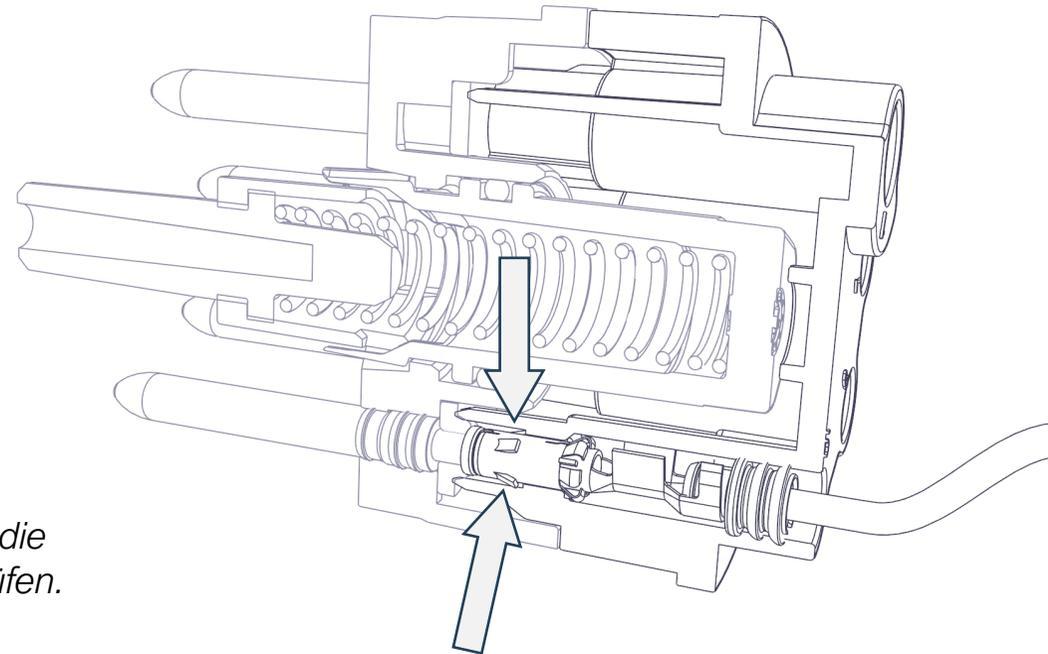
Gecrimpte Buchsenkontakte in den mit Massivkontakten bestückten Träger stecken und einrasten.
