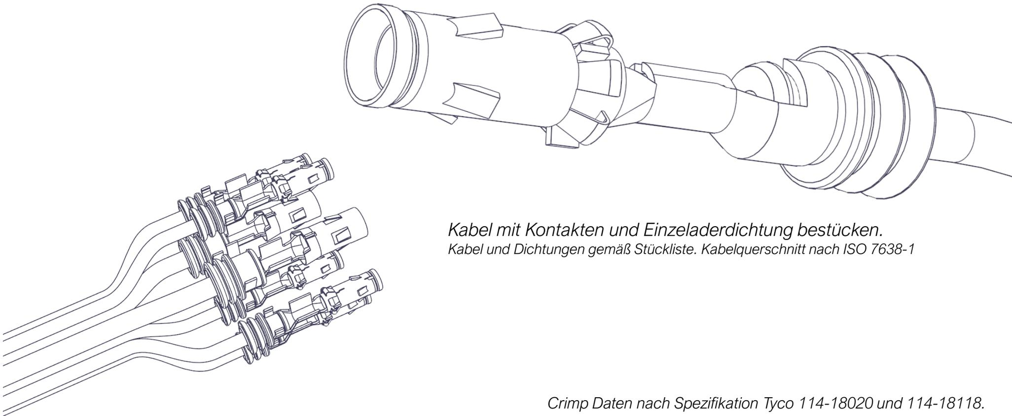
*Kabel mit Kontakten und Einzeladerdichtung bestücken.
