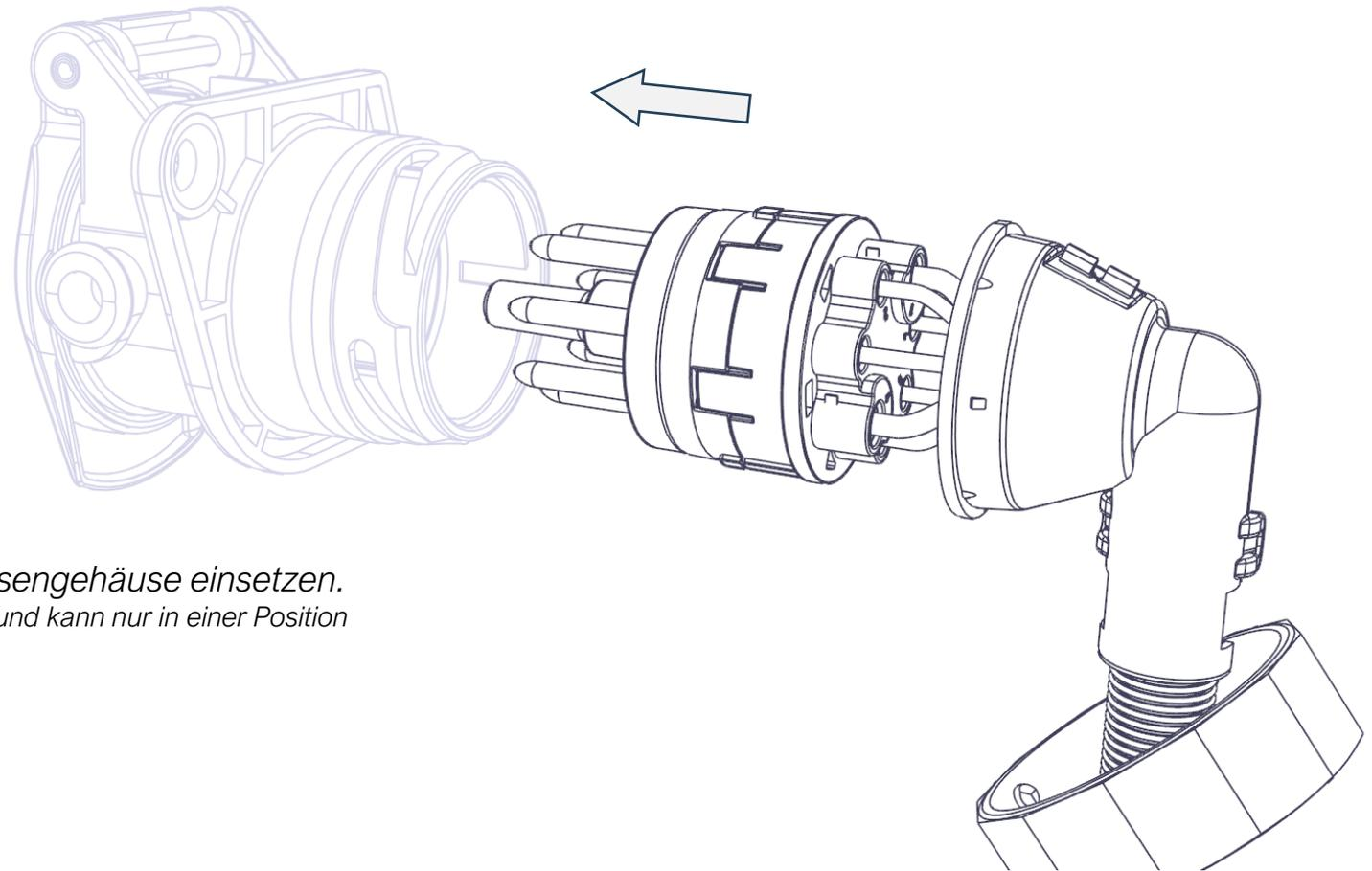
*Kontaktträger in Dosengehäuse einsetzen.
