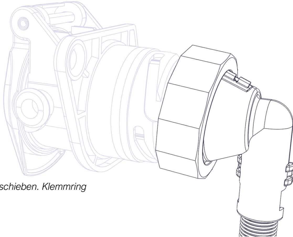
*Wellrohrabgang an das Dosengehäuse schieben. Klemmring auf Dosengehäuse drehen.*
